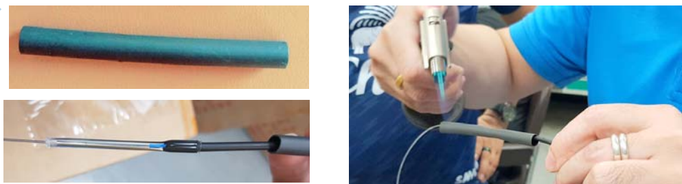
ภาพประกอบที่ 14. เชื่อมต่อสาย Nylon Optical Fiber กับสาย Round Type และหุ้มท่อหด
